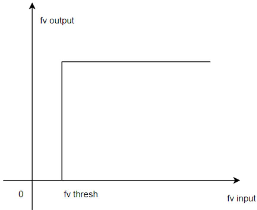
Fv threshold阈值是对滤波结果之后的LDG输出值做的阈值。
